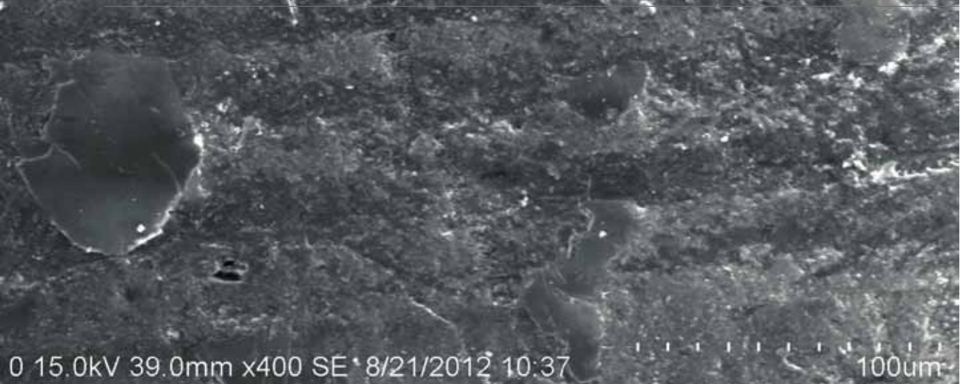
Vật liệu composite 3 pha nền polyester sợi thủy tinh sau khi bổ sung hạt nano titan oxit.
